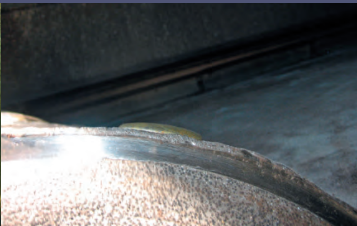
Bilden visar dels slitage på gängan, dels en mycket sliten rivartand bakom gängan.
